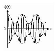
Рис. 2.14 Амплитудная модуляция
