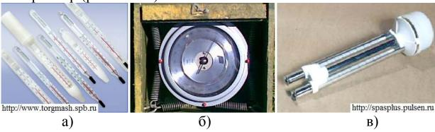
Рис. 2.11 Термометры, барометр, психрометр
