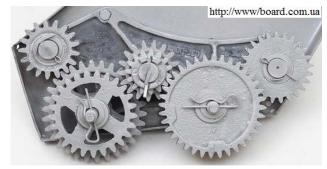
Рис. 2.23 Механический редуктор
